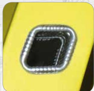
Piolo 30x30 mm a rombo inclinato di 68° che garantisce l'appoggio in piano dei piedi ed il non affaticamento delle gambe (brevetto)
