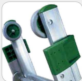
Staffe di scorrimento con anime di acciaio ricoperte di brillanti mescole in nylon, offrono totale sicurezza e proteggono le superfici dei montanti riducendo gli attriti. Grandi ruote Ø 100 mm in gomma chiara per scorrere a muro senza macchiare
